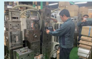
タブレット端末で金型のQRコードを読み込む
