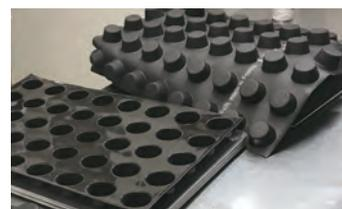
▲鉄製から軽量のシリコン製の焼き型に変えることで従業員の労力軽減と事故防止にもつながっている。
