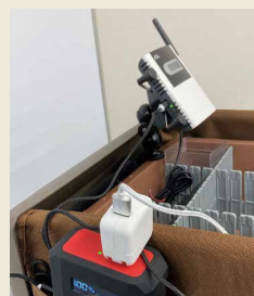
CO 2 センサーと モバイルバッテリー
