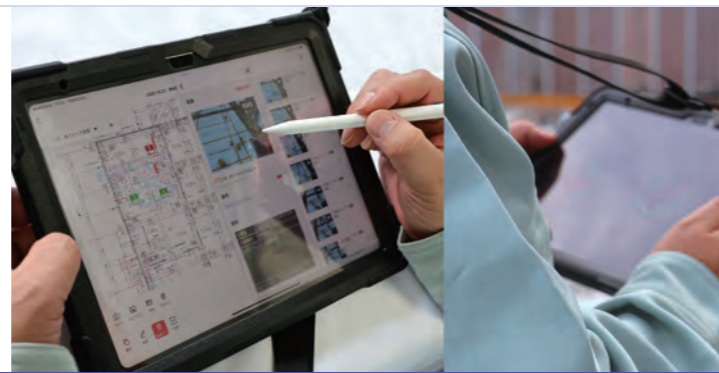
施工現場で施工図や写真等の共有がリアルタイムで可能に
