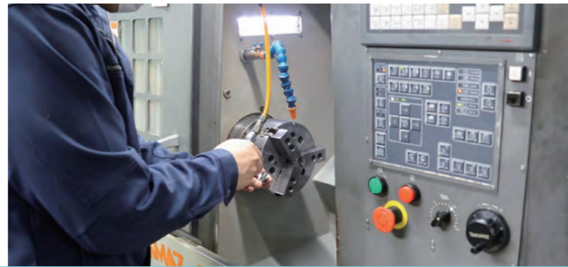
機械の頻繁な開閉作業によりオイルミストが工場内に飛散していた
