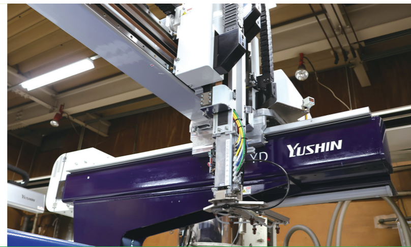
導入した横走行型取出機
